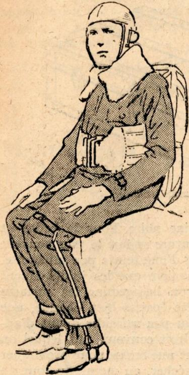
Fig. 2. — Equipement d'un passager avec un parachute dorsal.
